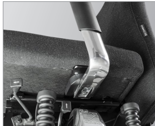
Armlehnen 1F mit Verstärkung und Polyurethan-Hartschaumauflage
